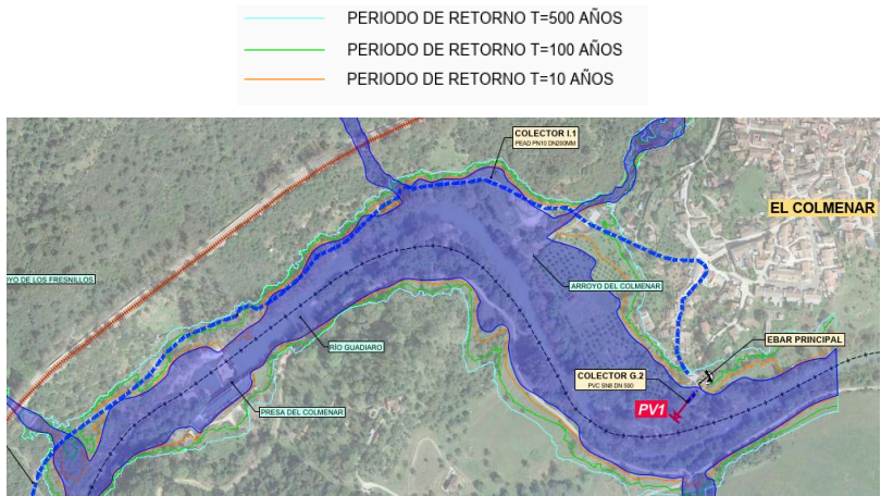
Trazado del colector G1 entorno al Río Guadiaro (fuente: Elaboración propia con datos de SNCZI)
